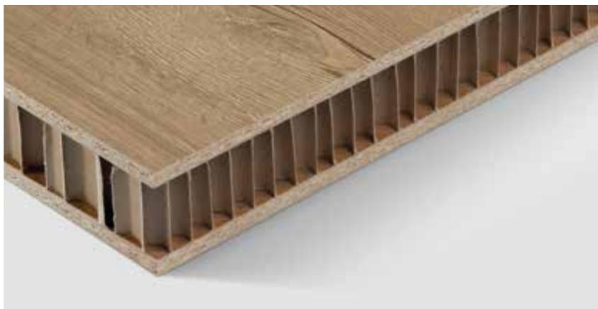
Die EGGER Eurolight Leichtbauplatte ist eine Verbundplatte mit stabilen Decklagen aus 4 bzw. 8 mm dicken Holzwerkstoffplatten, die einen leichten, jedoch robusten Sechseck-Kartonwabenkern umschließen. Trotz ihres geringen Gewichts verfügt sie über eine hervorragende Stabilität.
